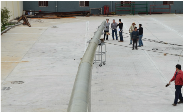
바스프 폴리우레탄 제품으로 만든 전신주에 대한 휨 정도 테스트 (extreme bending test)
